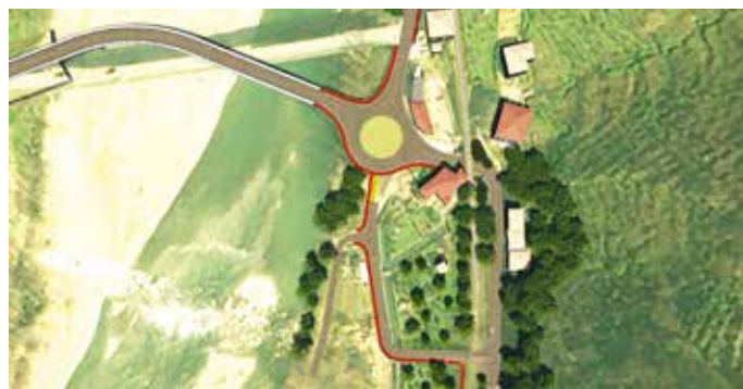
4A e 4B. Il ponte quasi interamente in rettilineo con la nuova rotatoria a monte del ponte crollato (4A) e in curva con nuova rotatoria a valle (4B)
